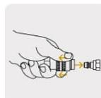
2 Conexiones rápidas de latón, salida 1/4"
