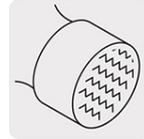
Cara fresada que permite un impacto sin deslizamiento
