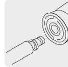
Sistema de conexión rápida para manguera
